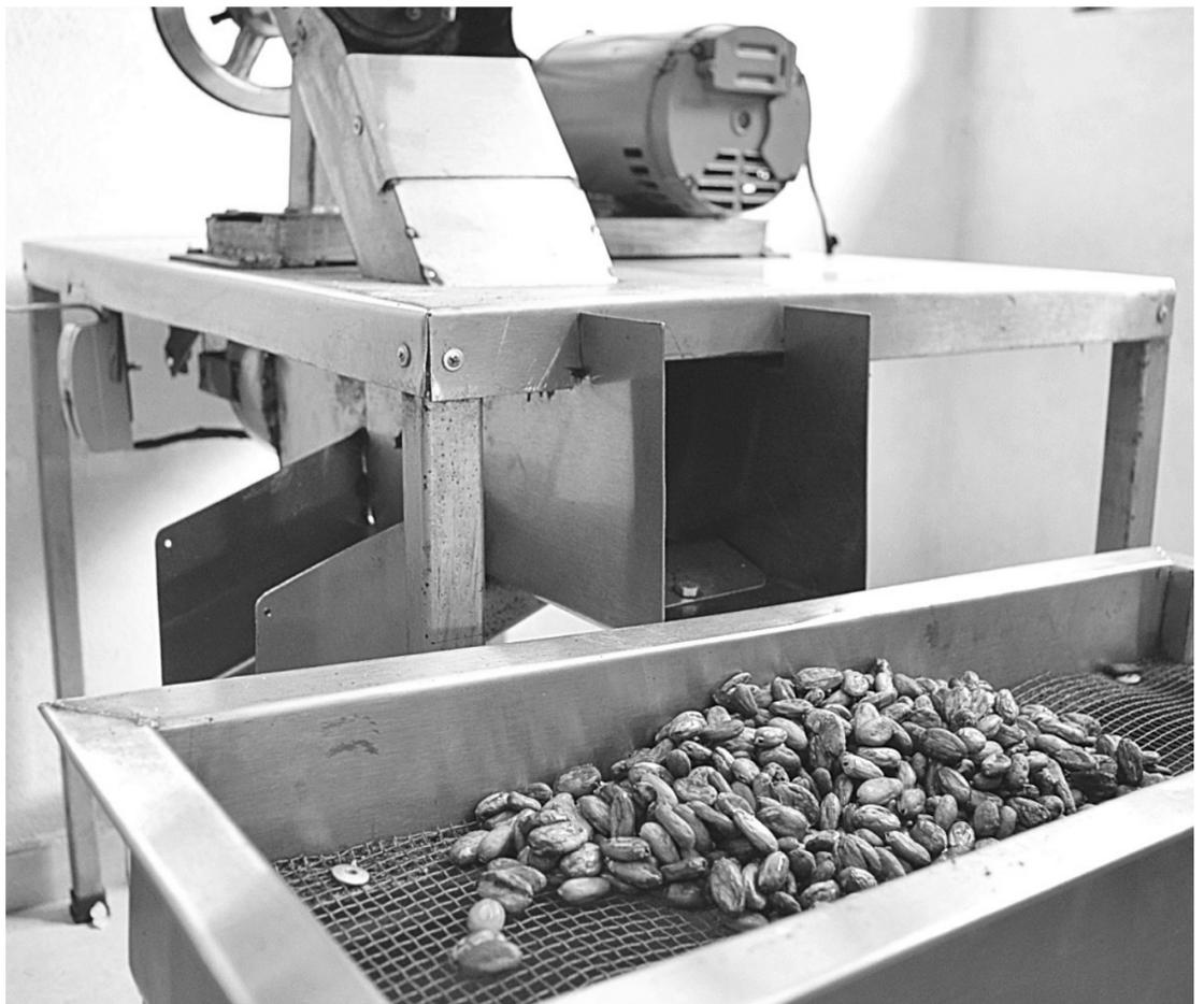
Después que las semillas de cacao han sido tostadas, se colocan en esta máquina para retirar la cáscara y posteriormente ser colocadas en los molinos.
