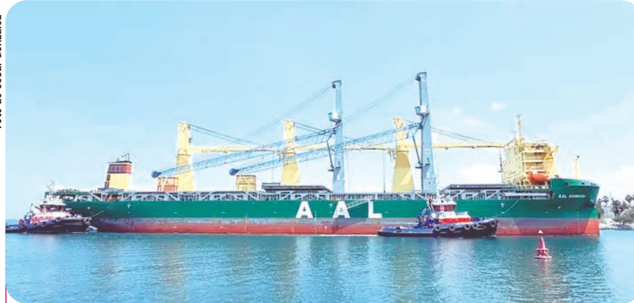
● Cada grúa tiene una capacidad de levante de 100 toneladas.
